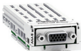
VW3A3422 analog encoder interface module
